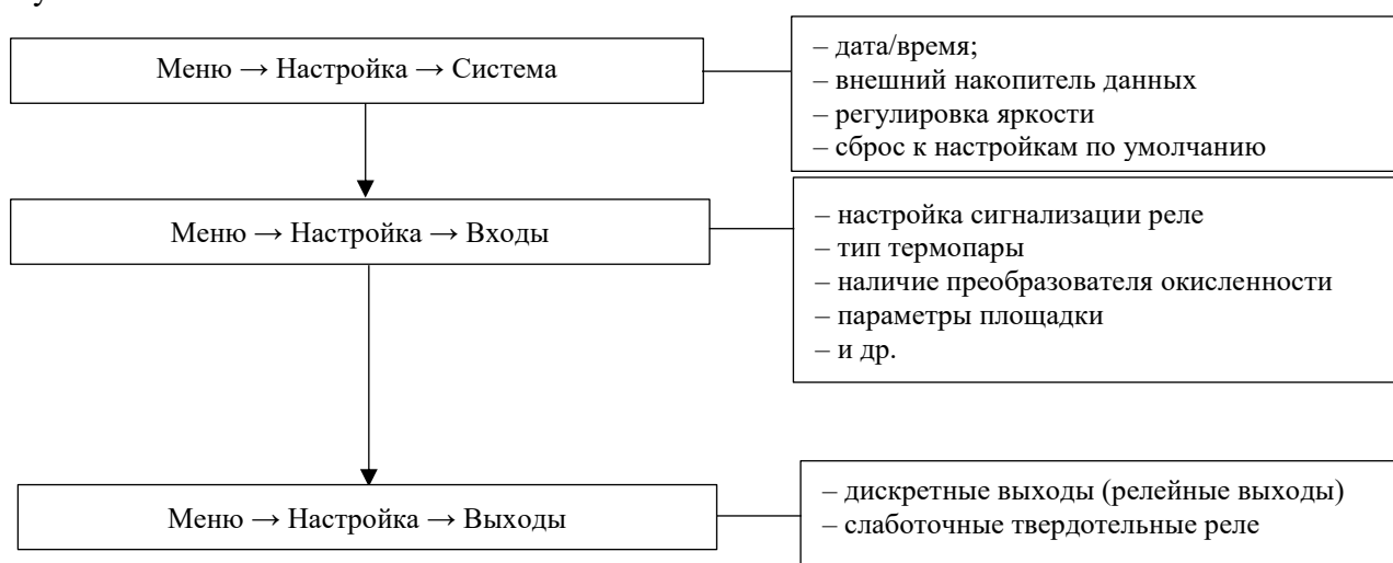
Рисунок 2.1 – Последовательность настройки прибора
